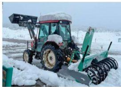
畑で使用しているトラクターの部品を除雪用に交換し、除雪を行っています。
